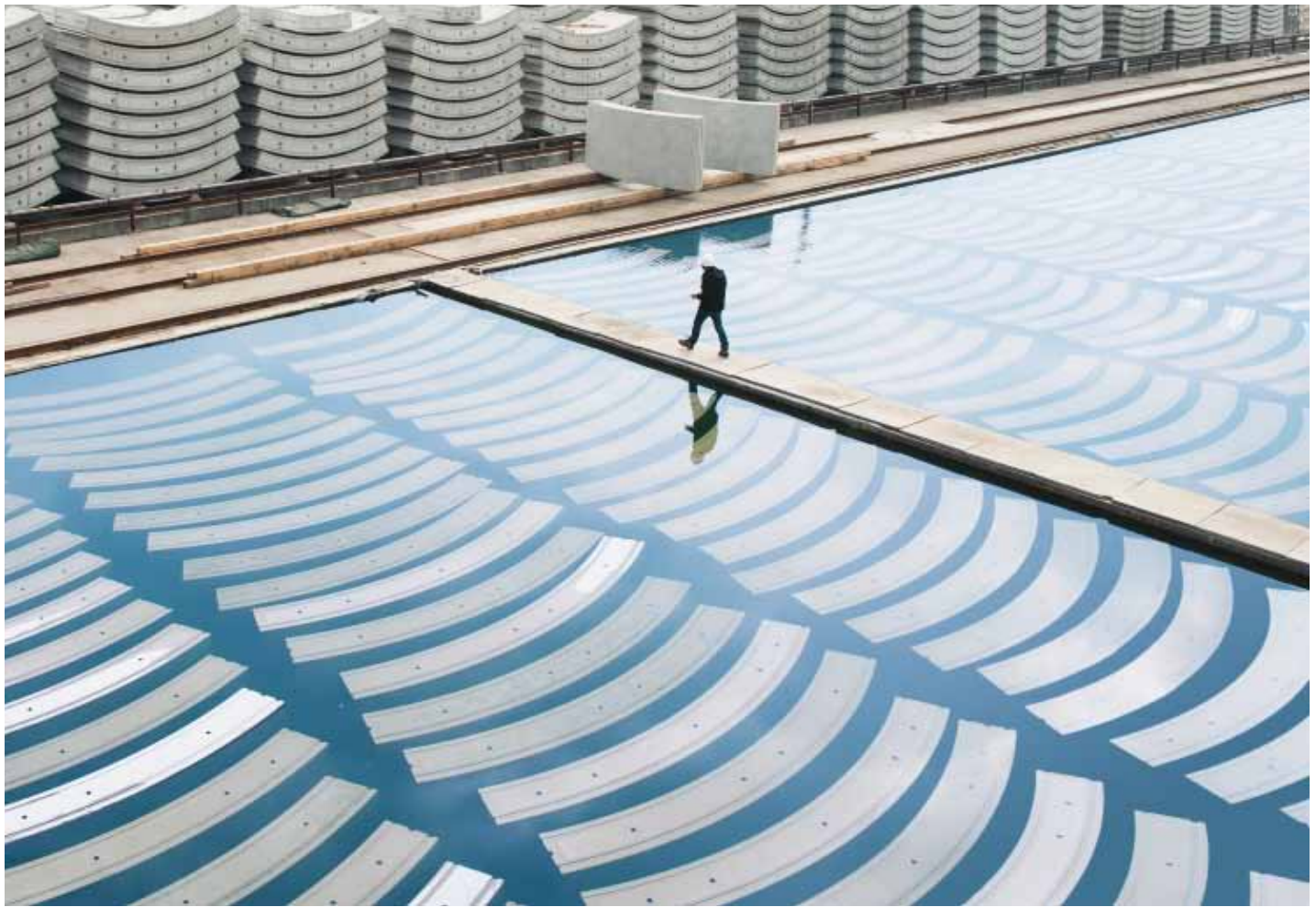
🔗 Verschalungselemente für 600 km Metro Bis 2030 werden jährlich 150 000 Verschalungselemente für die Metro der chinesischen Millionenstadt Nanjing produziert.
